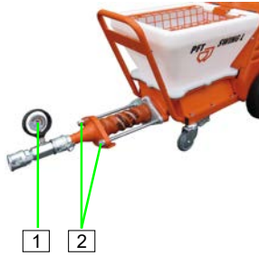
Abb. 56: Mörteldruck überprüfen und ablassen
